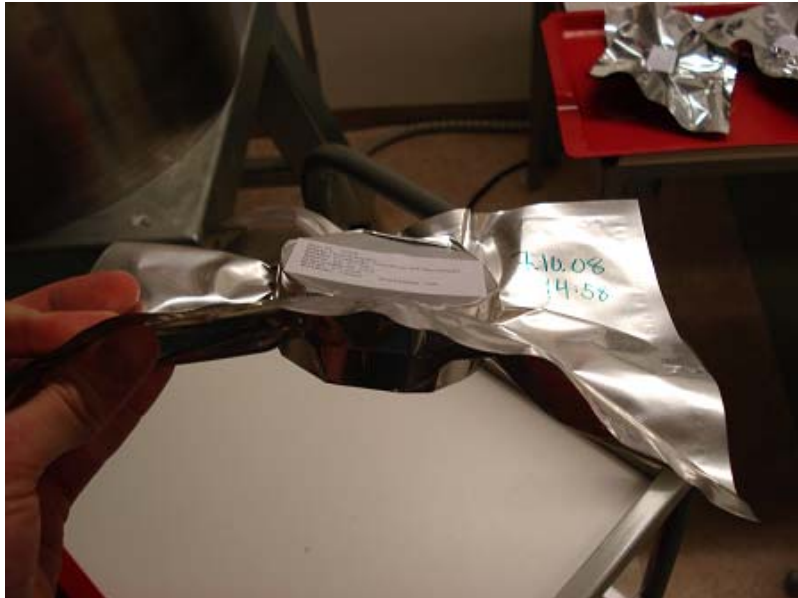
Kuva 9. Vakumoitu sedimenttinäyte. Näyteastia (T-purkki) on kuvan keskellä alumiini- sen pussin sisällä.
