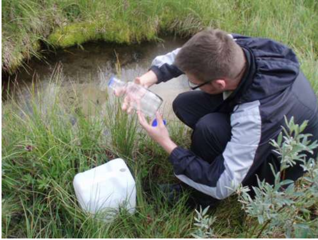
Kuva 4. Lähdeveden ottaminen parakkinen takaa litran lasipulloon radonin mittausta varten (STUK).
