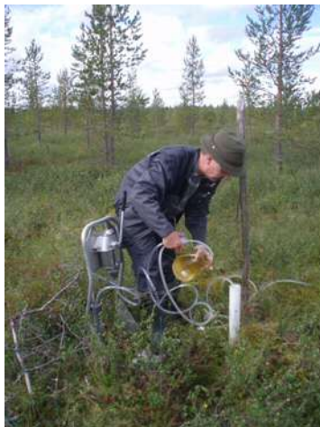
Kuva 3. Pohjaveden ottaminen suolta vanhan läjitysalueen takaa (Nab Labs).
