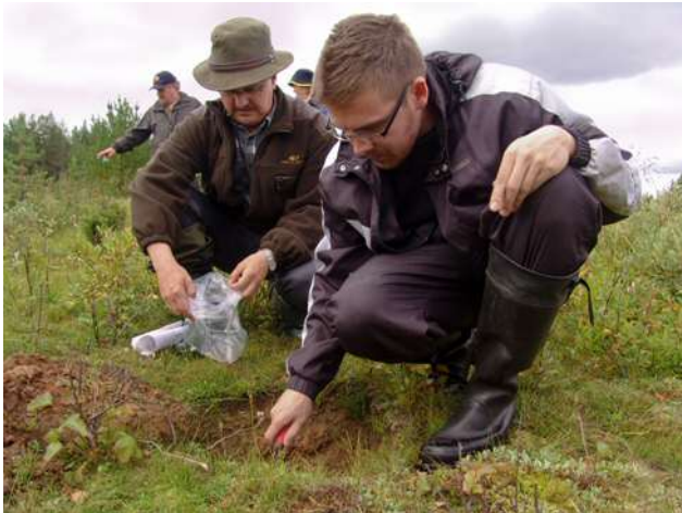
Kuva 5. Maanäytteenotto vanhalta läjitysalueelta (STUK ja Nab Labs).
