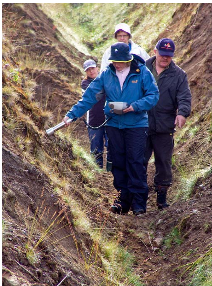
Kuva 7. STUK mittaamassa annosnopeutta niobimalmialueella.
