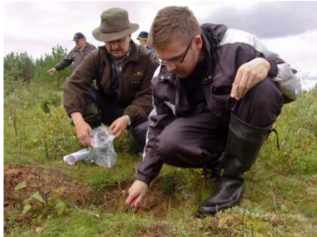
Kuva 8. STUK ottamassa maanäytettä vanhalta rikastushiekka-alueelta.
