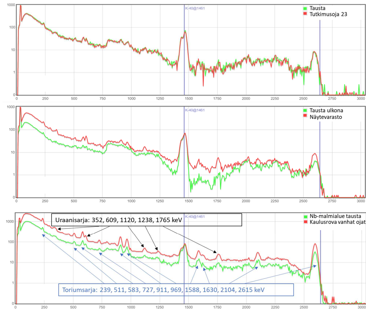
Kuva 2. STUKin tarkastuksella 5.9.2022 mitattuja gammasäteilyn energiaspektrejä Soklista. Sokli Oy:n peitetty tutkimusobjekti 23 on esimerkki kohteesta, joka ei erotu lähialueen taustasäteilystä (yläkuva). Sokli Oy:n näytevarasto (keskikuva) ja Kaulusrovan niobimalmialueen vanhat tutkimusobjektit (alakuva) ovat esimerkkejä kohteista, joissa on havaittavissa uraani- ja toriumsarjojen hajoamistuotteista johtuvia fotonipiikkejä, joiden intensiteetti on hieman taustasäteilyä suurempi. Myös niobimalmialueen taustasäteilyn spektrissä on havaittavissa samat fotonipiikit, mutta pienemmällä intensiteetillä kuin ojissa. Energiat ovat merkittyinä näkyviin vain alimpaan kuvaan. Suuri piikkiyhdistelmä 1438–1461 keV kohdalla johtuu kalium-40:stä sekä ilmaisimen kiteen sisältämästä lantaani-138:sta.
